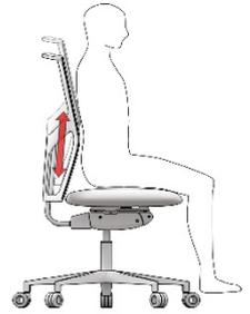
Estructura de respaldo en inyección plástica de nylon color negro o blanco, reforzado con 15% de fibra. Respaldo en malla técnica de alta resistencia cuyas características son:
